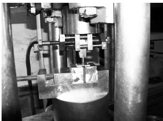
Рис. 1. Изгиб образцов на УИМ 50М (по ГОСТ 14019)
