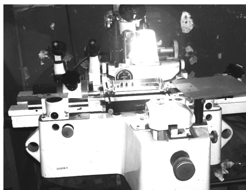
Рис. 2. Замеры образцов с помощью инструментального микроскопа БМИ
